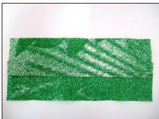
Накладной шов с двумя закрытыми срезами
